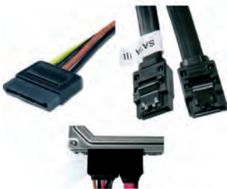
Рис. 1 Подключённые разъёмы к HDD
