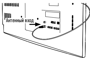
Рис.2 Подключение антенны к телевизору в исполнении RX-263
