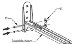
2. Для регулировки вылета кронштейна используйте фиксирующий болт снизу держателя. По окончании регулировки зафиксируйте болт.
