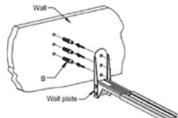
4. Приложите стеновую пластину к стене, вставьте три самореза (А) в дюбеля (В) через шайбы (С) и прочно зафиксируйте пластину на стене.
