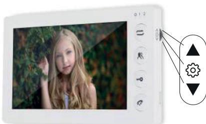
Кнопка «⚙» у домофонов AC-332, AC-333, AC-334, AC-335 и AC-337 - «Настройки», имеет три разных направления нажатия для использования навигации по экранному меню монитора. В режиме ожидания нажмите на кнопку «Настройки», для входа в настройки параметров работы домофона, а для навигации по разделам меню нажмите кнопку «Вверх» или «Вниз». Для домофонов AC-336, AC-338, AC-339, AC-340 для входа в меню нажмите кнопку ⚙ «Настройки» на передней панели.
