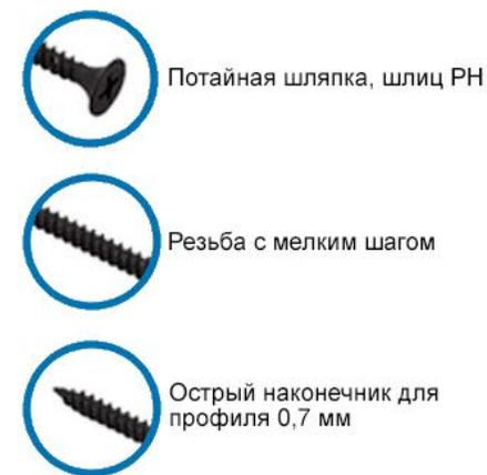
У саморезов по дереву резьба крупная, что позволяет надежно закрепиться в таких мягких материалах, как древесина, пластик, фанера, дсп и т. д. А у саморезов по металлу резьба мелкая. Она надежно фиксируется в тонколистовом металле (профили для гипсокартона).
