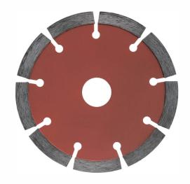
**Диск алмазный –** специальное соотношение пропорций элементов алмазного слоя подобрано таким образом, чтобы по мере истирания алмазов стирался связующий слой и зачищались алмазы из внутренних слоев, в зависимости от материала назначения дисков. Применяются совместно с углошлифовальными машинами (УШМ/болгарка).
