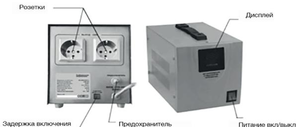
При подключении приборов к стабилизатору загорается индикация НАГРУЗКА и ЗАДЕРЖКА, после чего происходит обратный отсчёт времени. После проверки уровня входного напряжения, в случае если оно находится в допустимых пределах, стабилизатор подает питание на подключенные электроприборы. При нормальной работе на дисплее отображается РАБОТА, значения входного и выходного напряжения, а также уровень загруженности НАГРУЗКА.
