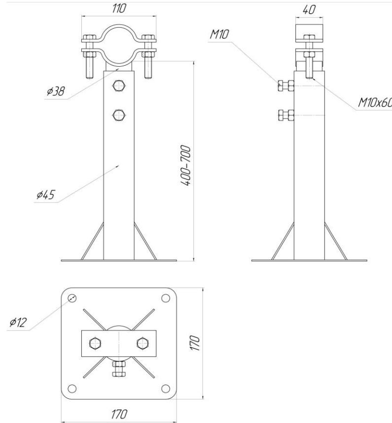
ВНИМАНИЕ! ПЕРЕД УСТАНОВКОЙ УБЕДИТЕСЬ, ЧТО КРЕПЛЕНИЕ И ПОВЕРХНОСТЬ, НА КОТОРУЮ УСТАНАВЛИВАЕТСЯ КРОНШТЕЙН ВЫДЕРЖАТ ВЕС КРОНШТЕЙНА С ОБОРУДОВАНИЕМ УСТАНОВЛЕННЫМ НА НЕГО
