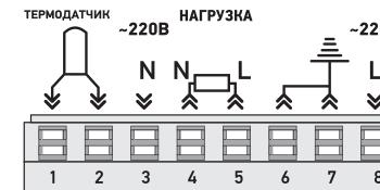
Порядок подключения клемм
