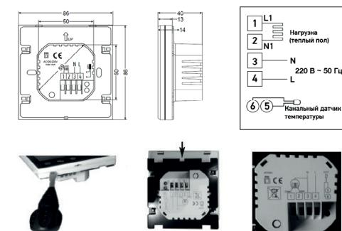
Чтобы вскрыть терморегулятор, поместите конец плоской отвертки в обе разъемы в основании терморегулятора.
