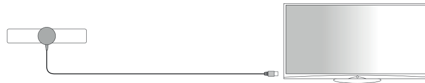
Рис. 3 Подключение антенны к телевизионному цифровому приемнику DVB-T2
