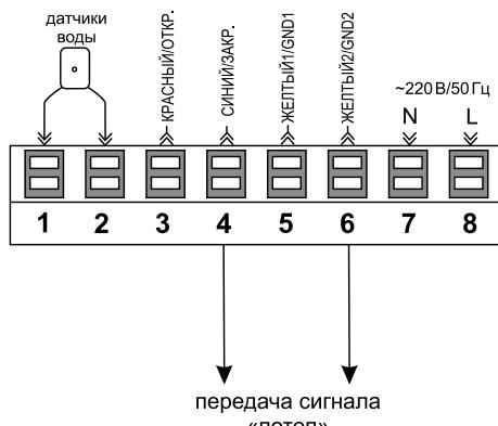
При возникновении неполадок в контроллере или редукторе крана – GND2/красный – сигнал о неисправности системы.
