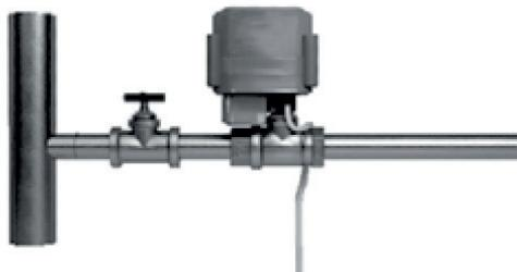
Допускается наращивание соединительного провода шарового крана до 20 м проводом сечением не менее 3x0,5 мм<sup>2</sup>. Соединение выполняется через распаячную коробку. Кран шаровой предусматривает возможность принудительного открытия вращением рукоятки, расположенной на крышке исполнительного механизма.
