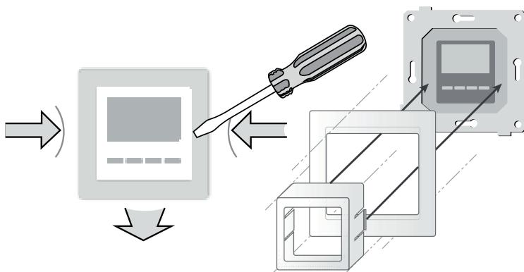
3. Снимите заднюю крышку контроллера и подключите АКБ.
