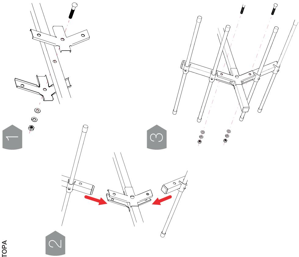
**СХЕМА СБОРКИ УЗЛА КРЕПЛЕНИЯ**
